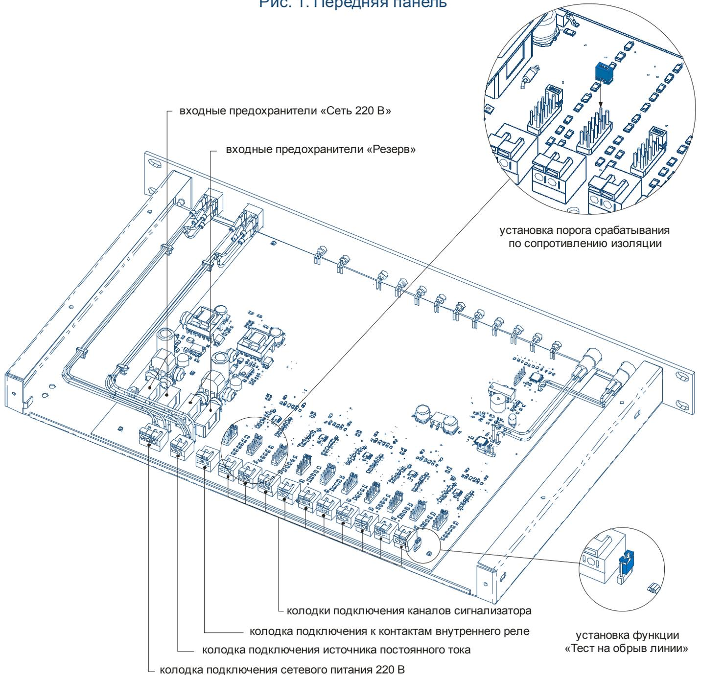
Рис. 2. Вид сверху со снятой крышкой
